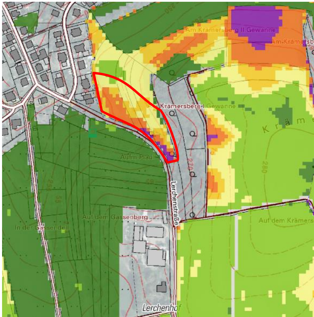
Abbildung 14 Erosionsgefährdung Hanglage „Lerchenstraße“
